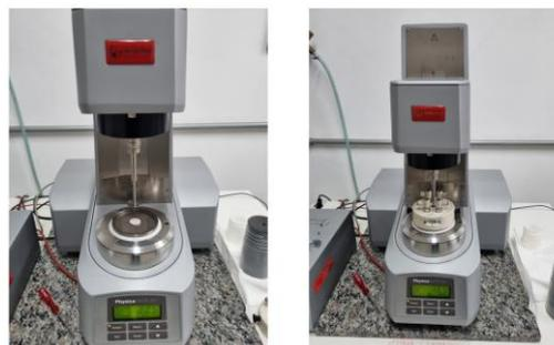
Figura 3 – Reômetro utilizado no ensaio: sem (esquerda) e com (direita) a presença da cela magnética acoplada
