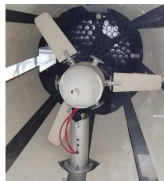
Figura 2 - Turbina instalada na seção de testes. Fonte: Autoria própria.
