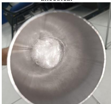
Figura 5 – Detalhe da lâ de vidro inserida na terminação anecóica.
