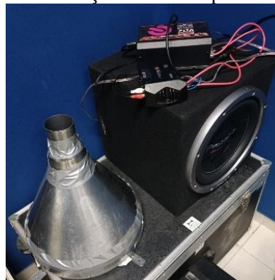
Figura 7 – Caixa acústica com amplificar, fonte de alimentação e cone adaptador.
