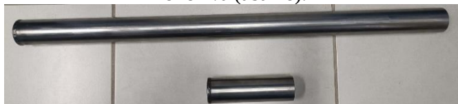
Figura 4 – Terminação anecóica (acima) e terminação reflexiva (abaixo).
