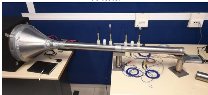
Figura 4 – Terminação anecóica (acima) e terminação reflexiva (abaixo).
