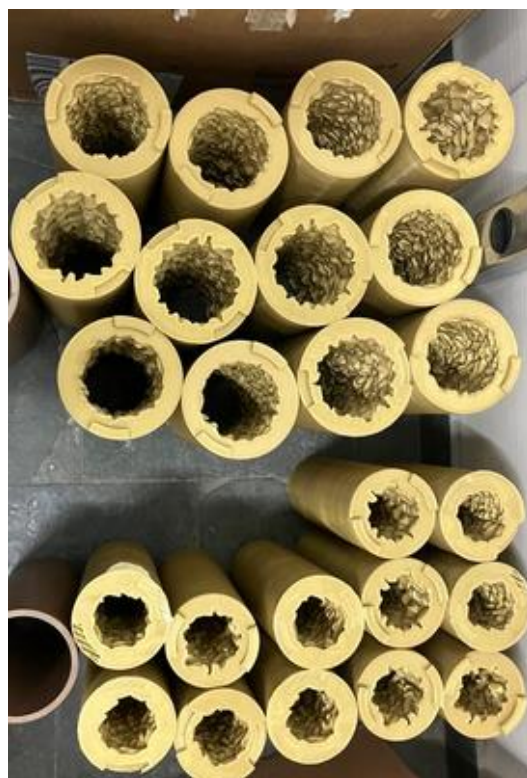
Figura 1: Impressão 3D da rugosidade interna causada pela bioincrustação do Mexilhão Dourado.
