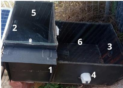
Os números 1, 2, 3 e 4 correspondem a entrada do secador, a ventoinha superior e inferior e o potenciômetro, respectivamente. Já as áreas compreendidas pelos números 5 e 6, correspondem à câmara de secagem e ao coletor solar, respectivamente.
