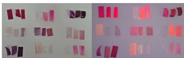
Figura 2 – Filmes de PVA contendo os nove derivados de espiropiranos (na ordem: SPNC 2 , SPOH, SPOCH 3 , SPOCH 3 M, SON, SPSO, SOH, SNAP, sendo primeiro o filme com PVA e o espiro, em seguida o filme com zinco e, por último, cálcio) obtidos após otimização
