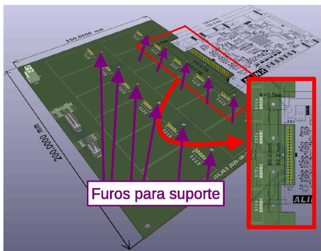
Figura 4 – Renderização 3D da segunda versão da placa mãe digital J10, com as devidas correções
