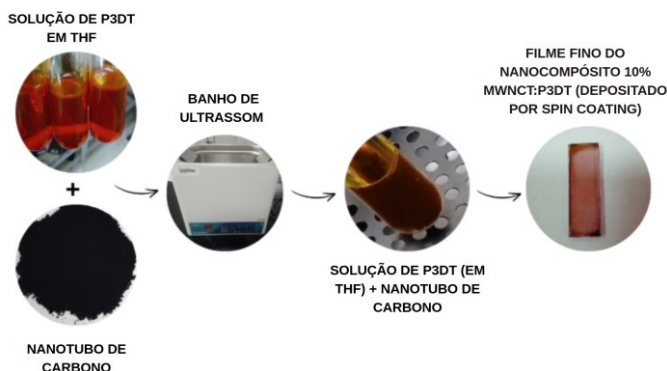
Figura 2: Esquema de obtenção dos nanocompósitos.
