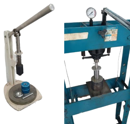
Figura 1 – À esquerda, forma para pastilha e, à direita, prensa isostática.
