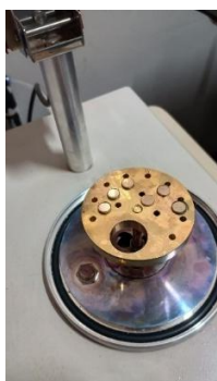
Figura 3 – Spotering aberta com pastilhas banhadas a ouro.
