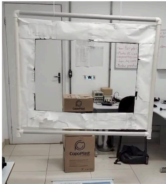
Figura 2 - janela vazada (gate) improvisada para teste.
