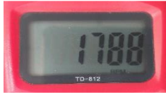
Figura 6 – Leitura da velocidade do motor.
