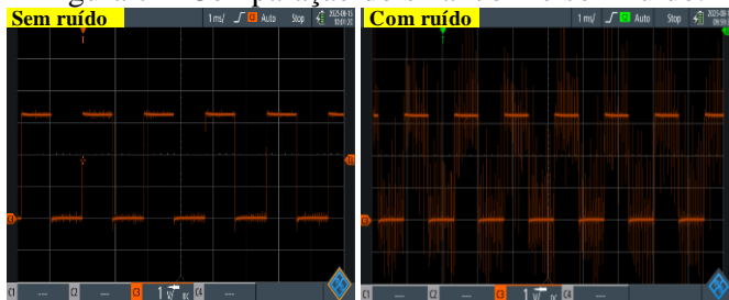
Figura 7 – Comparação do sinal com e sem ruído.
