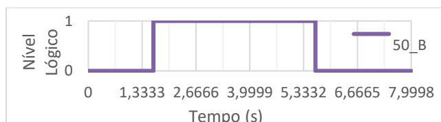
Figura 5 – Sinal de trip da saída binária do CPC por atuação da função ANSI 50 (50_B).
