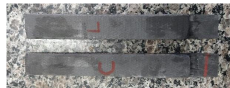
Figura 3.1 – Finalização das vigas com núcleo de cola branca (abaixo) e látex (acima)
