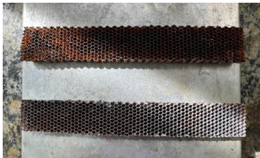
Figura 2.2 – Honeycomb parcialmente preenchido com latex e pó ferromagnético (acima) x Honeycomb parcialmente preenchido com cola branca e pó ferromagnético (abaixo)
