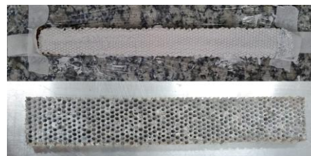
Figura 2.1 – Honeycomb totalmente preenchido com silicone e pó ferromagnético (acima) X Honeycomb parcialmente preenchido com silicone e pó ferromagnético (abaixo)
