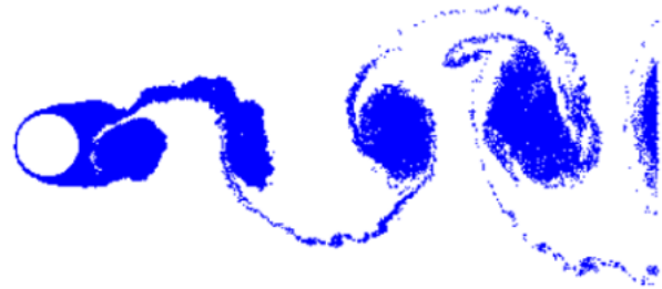
Figura 2 - Formação da esteira de vórtices no caso 1: sem efeitos de paredes
