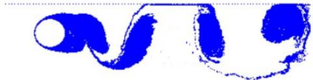
Figura 6 - Formação da esteira de vórtices no caso 2: efeito de parede superior
