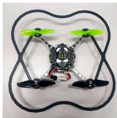
Figura 1 – Drone Crazyflie 2.0 montado com proteção de hélices impressa em 3D.
