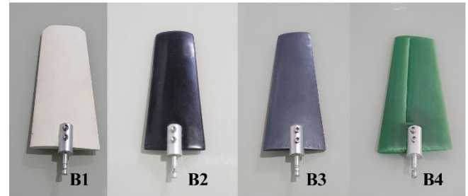
Figura 4 – Quatro pás da turbina utilizadas no experimento. Autores.
