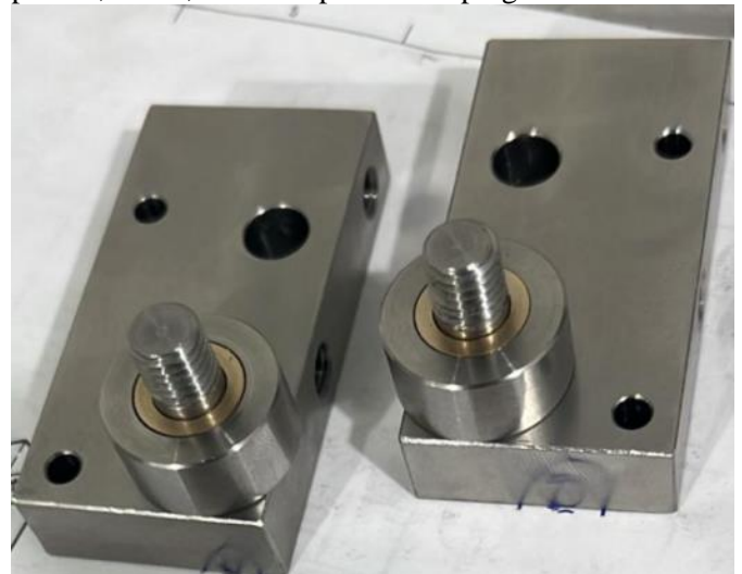
Figura 5 – Terceiro protótipo: cabeçote com roldanas em inox e sistema de calibragem fina
