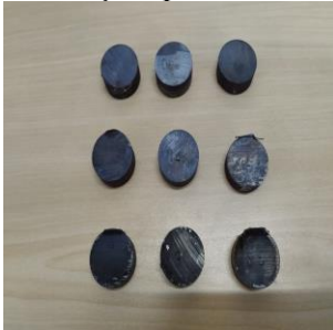
Figura 6 - Peças após o revenimento.
