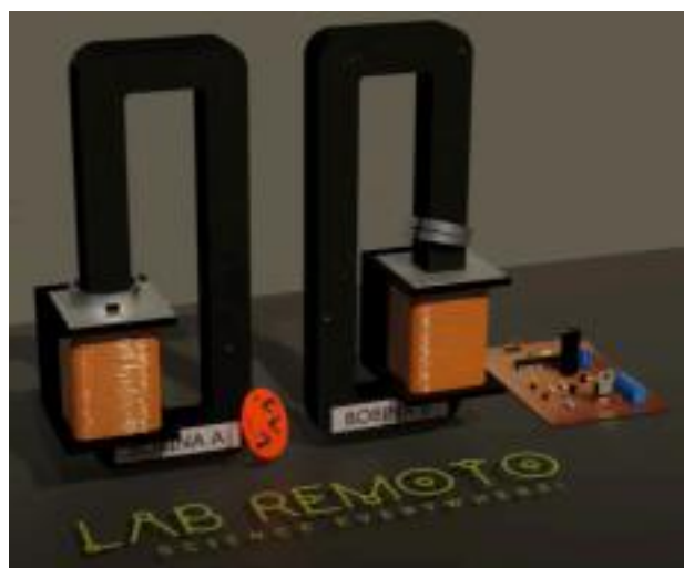
Figura 3 - Modelo 3D do Ex. Anel de Thomson
