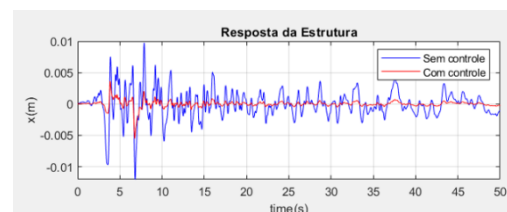
Figura 3 - Resultados da simulação do sistema dinâmico da estrutura após o uso do controlador PID. Fonte: O Autor (2022).
