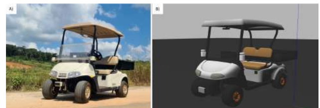
Figura 10 – Carrinho de golfe (a) implementado no ambiente Gazebo (b).
