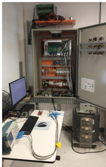
Figura 1 - Bancada desenvolvida para estudos de sistema de armazenamento de energia combinado com geração fotovoltaica.
