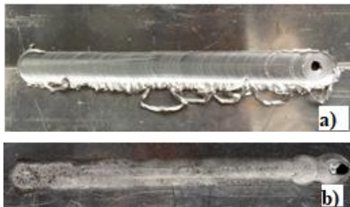
Figura 7 - (a) topo da solda com o parâmetro escolhido; (b) raiz da solda com o parâmetro escolhido.
