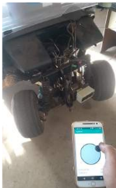
Figura 7 – Ensaio do aplicativo de tele-operação com carrinho de golfe. Fonte: Autor.
