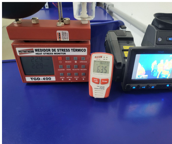
Figura 1 – Instrumentos utilizados: Medidor de stress térmico (à esquerda), datalogger de temperatura e umidade relativa (centro) e câmera termográfica (à direita)
