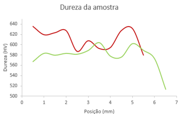
Figura 4 – Ensaio de microdureza Vickers da liga 26Al16Cr17Fe7Nb34Ni no estado bruto de fusão.
