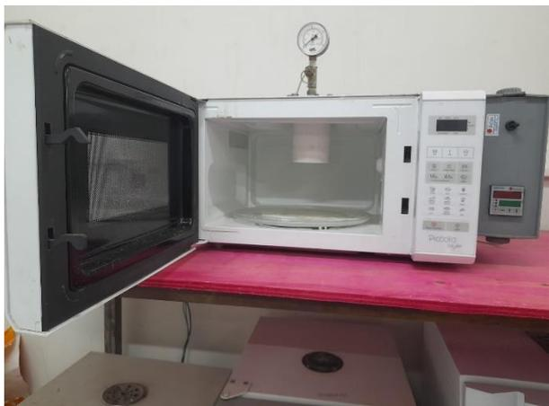
Imagem 2: Forno Micro-ondas com reator de Teflon.
