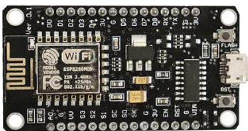
Figura 3- Módulo WiFi ESP8266 NodeMcu v3 - Lolin
