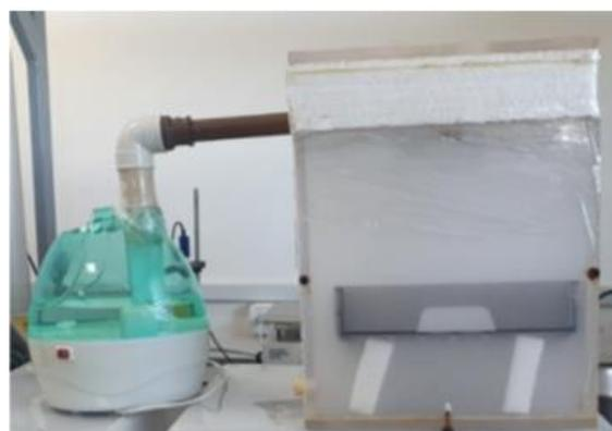
Figura 1 – Esquematização da câmara de névoa salina unida ao umidificador.
