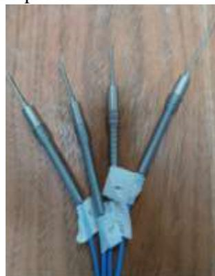
Figura 5 - Termopares tipo T utilizados.
