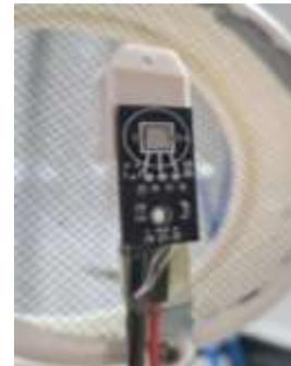
Figura 4 - Sensor de umidade relativa do ar e temperatura AHT10.
