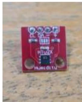
Figura 3 - Sensor de umidade relativa do ar e temperatura HTU2X.
