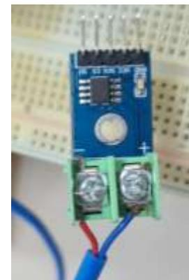
Figura 6 - Módulo MAX6675 conectado a um dos termopares.
