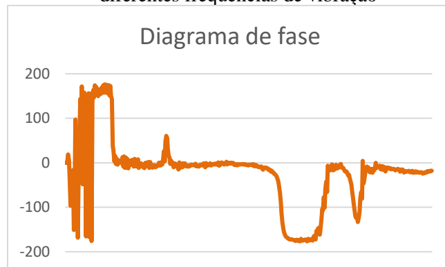
Figura 6 – Diagrama indicando a mudança de fase nas diferentes frequências de vibração
