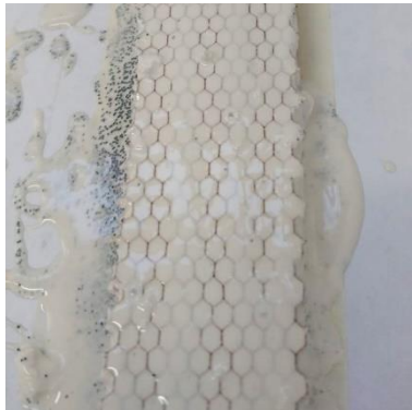
Figura 1 - Núcleo de aramida preenchida com elastômero MR
