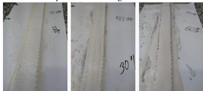
Figura 2 – Núcleos das vigas sanduíche preenchidos (Autores, 2023).
