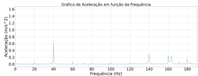
Figura 1 – Envelope do espectro de frequência do ensaio com o rolamento com defeito na gaiola induzido.
