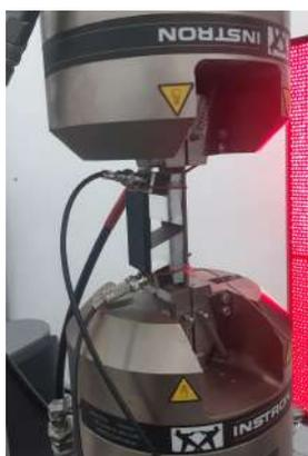
Figura 2 – Amostra posicionada na Máquina Universal de Ensaios.
