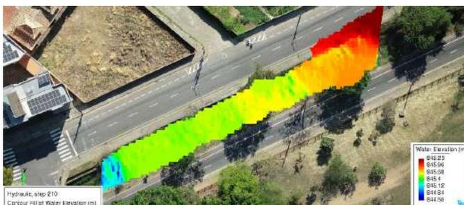
Figura 8: Altitude da água no trecho, para a vazão de 25m<sup>3</sup>/s
