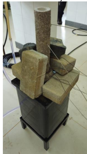
Figura 3 – Aparato de solidificação direcional montado.
