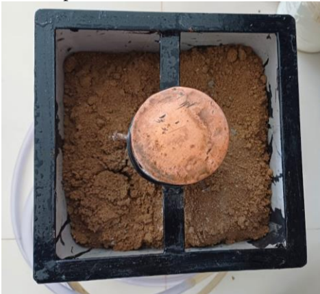
Figura 1 – Coquilha de cobre refrigerada à água sobre o suporte metálico preenchido de areia.
