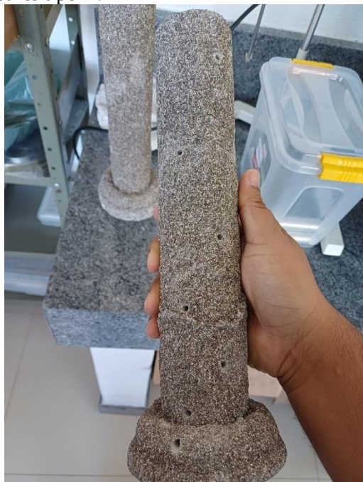
Figura 2 – Casca cerâmica com os furos para inserção dos termopares tipo K.
