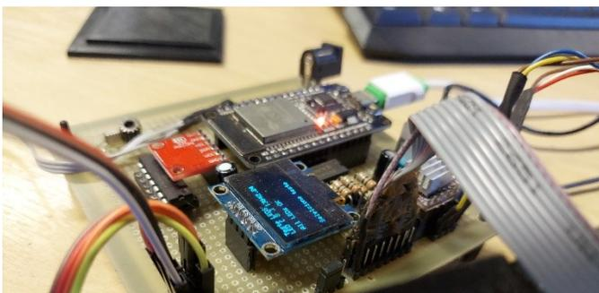
Figura 4 – Sensores auxiliares e microcontrolador ESP32.
