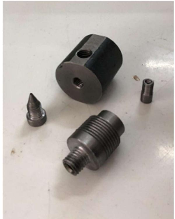
Figura 6 - Bico de co-extrusão (desmontado).
