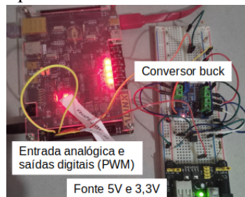
Figura 4 – Montagem do conversor buck e sua ligação à placa ALINX.
