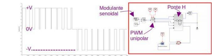
Até o momento, foram apresentados os resultados obtidos no Scilab/Xcos. As mesmas simulações foram repetidas no ngspice. A Figura 4 apresenta o diagrama de simulação da ponte H com modulação unipolar, desenhada no software kicad (esse passo é necessário para a geração de um arquivo netlist).
