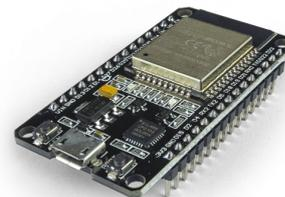
Figura 5 - microcontrolador ESP32
