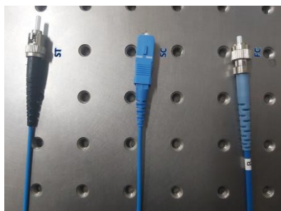
Figura 1: Conectores dos tipos ST, SC e FC, todos com polimento PC.
