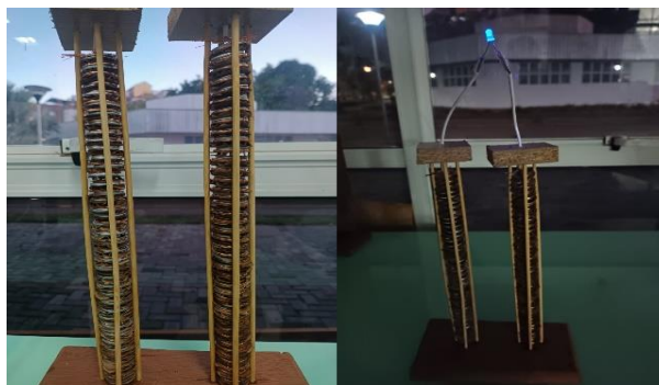
Figura 2: A estrutura montada (à esquerda) e acendendo uma lâmpada de LED (à direita).
