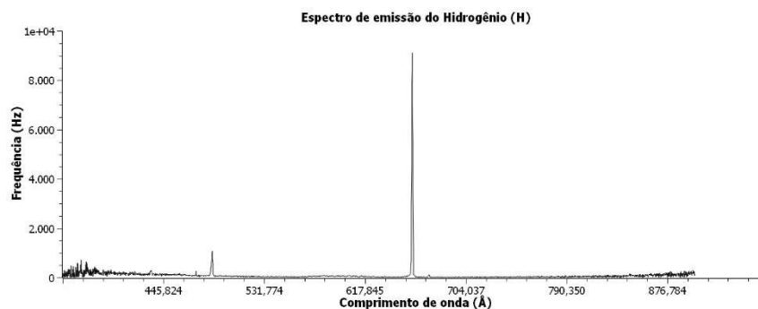
Figura 01: Espectro de emissão do Hidrogênio (H) gerado no software SciDAVis
