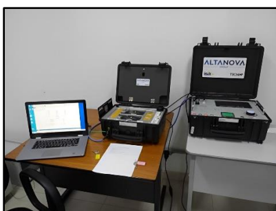
Figura 3: Equipamentos para simulação de DP
