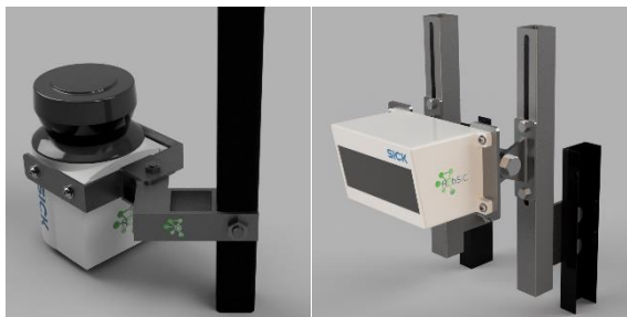
Figura 3 – Suportes para os LiDAR's laterais (esquerda) e frontal (direita). Fonte: Autor.
