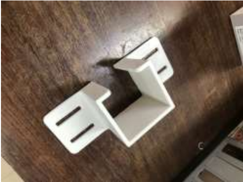
Figura 1 - Suporte do motor de passo impresso em 3D.
