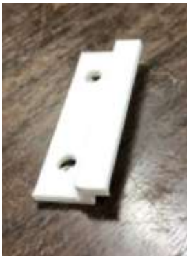
Figura 2 - Apoio do suporte impresso em 3D.
