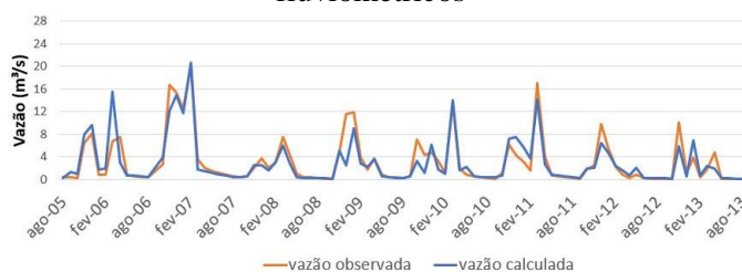
Figura 7 – Ajuste SMAP para a área dos dois postos fluviométricos
